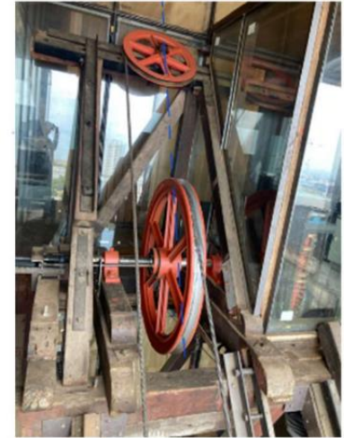
Verificación de Paralelismo de sistema poleas y cables respecto al Plano de rodadura
