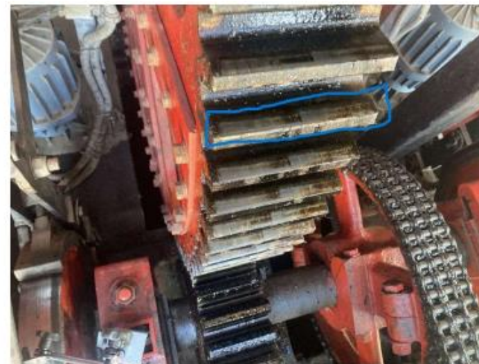
Condición pareja de enfrentamiento Dientes. Diente en toda su extensión limpio de grasa, se observa que en toda la extensión de los dientes se ejerce contacto. Es lo correcto que debe suceder.
