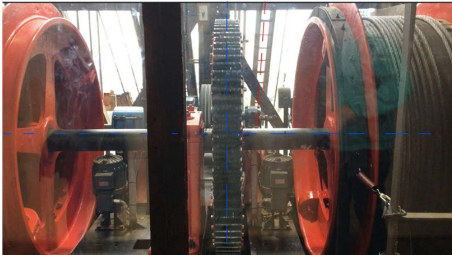
Ortogonalidad de sistema ejes motrices respecto a Plano de Rodadura.
