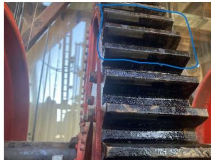
Condición despareja de enfrentamiento Dientes. Diente en la mitad de su extensión limpio de grasa, lo que acusa que en esa parte se ejerce contacto directo entre dientes.
